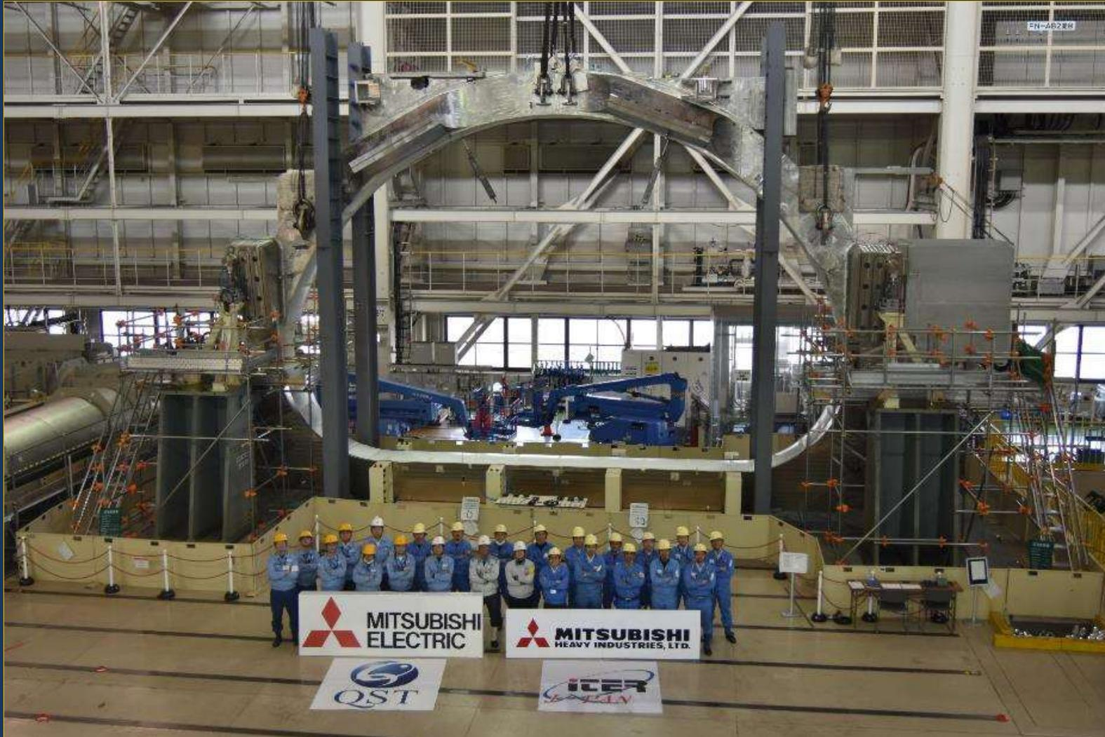
Dans les ateliers de Mitsubishi Heavy Industry, au Japon, insertion verticale du bobinage d'un aimant de champ toroidal (TF) dans son boîtier. L'ensemble pèse plus de 300 tonnes et les tolérances d'assemblage sont de l'ordre de 0,2 millimètres.
