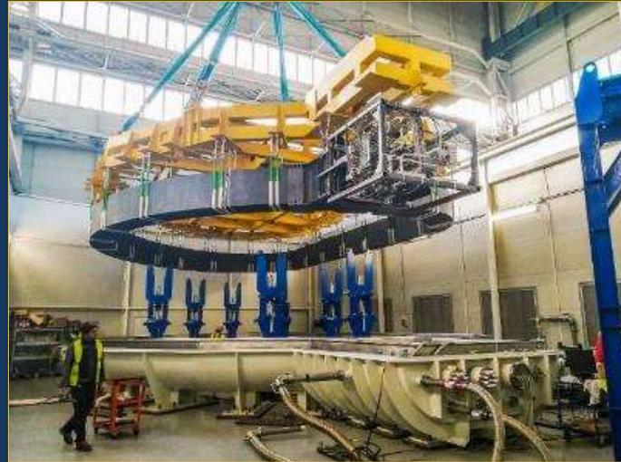
Bobines de champ toroïdal: les 70 « doubles galettes » destinées aux dix bobines verticales (sur un total de 19) et dont la fabrication incombe à l'Europe sont réalisées. La première bobine a été livrée sur site au mois d'avril 2020, la seconde en septembre, la troisième en décembre.
