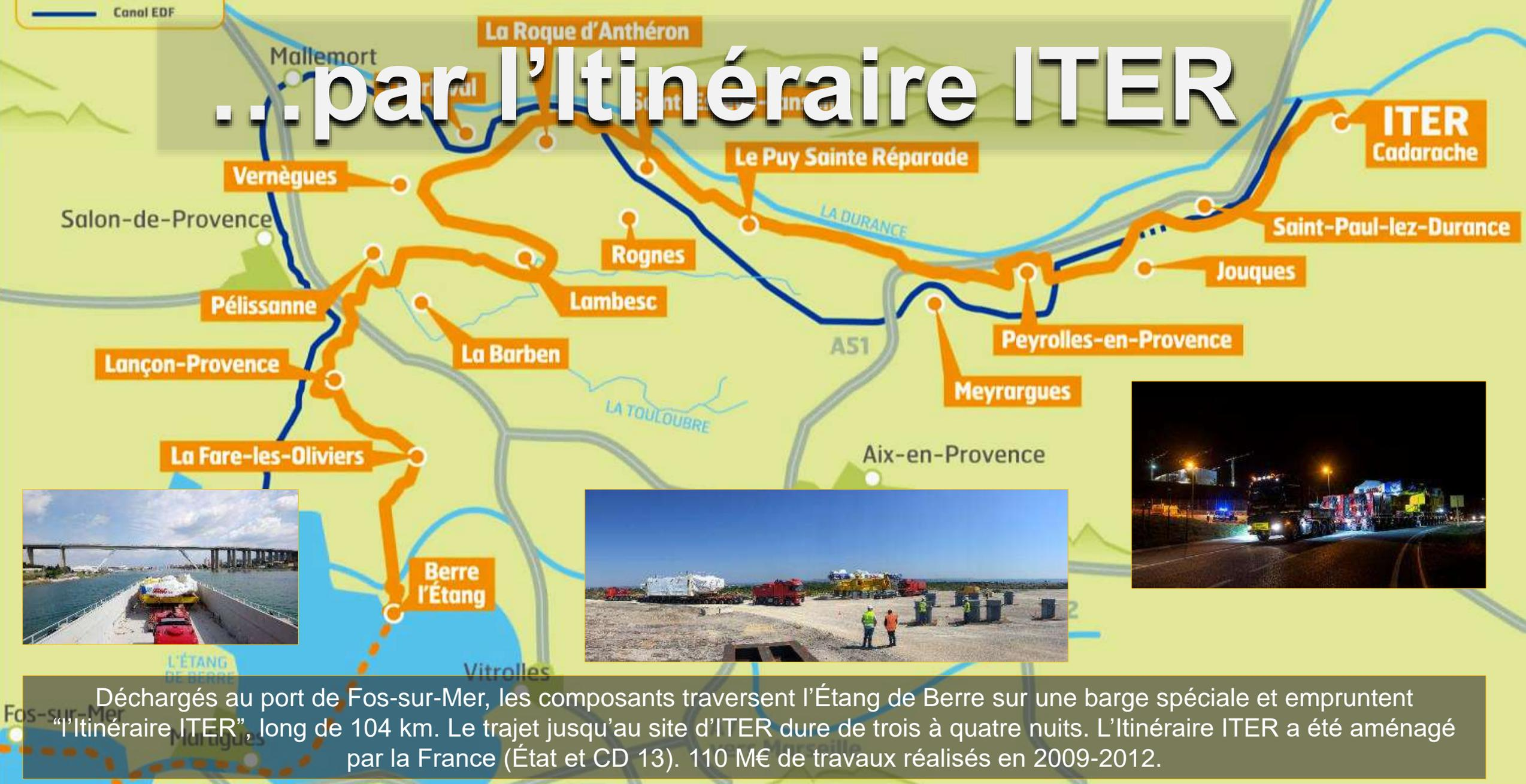
Déchargés au port de Fos-sur-Mer, les composants traversent l'Étang de Berre sur une barge spéciale et empruntent "l'itinéraire ITER", long de 104 km. Le trajet jusqu'au site d'ITER dure de trois à quatre nuits. L'itinéraire ITER a été aménagé par la France (État et CD 13). 110 M€ de travaux réalisés en 2009-2012.
