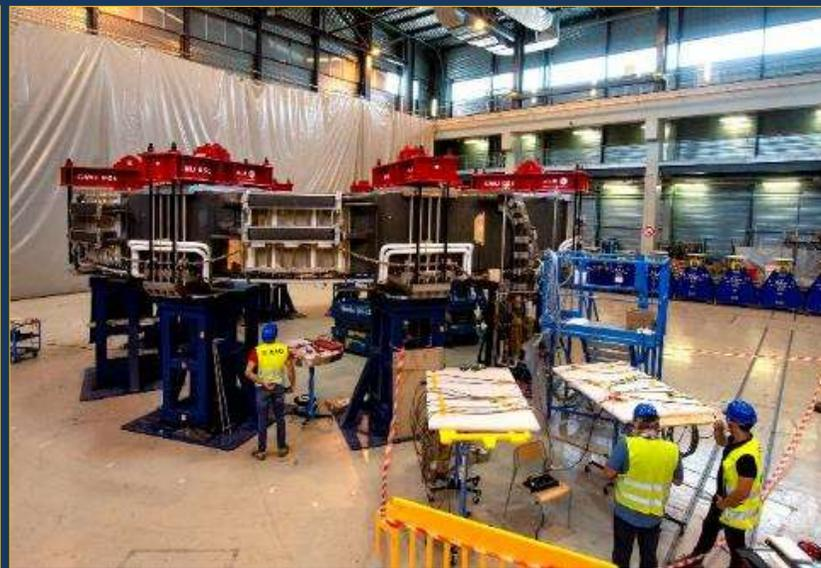
Livrée sur site le 26 juin, la bobine de champ poloidal n°6, fournie par l'Europe et fabriquée en Chine, a été finalisée sur site. Elle a passé avec succès les tests à très basse température et sera insérée dans le puits d'assemblage de la machine au mois d'avril 2021.
