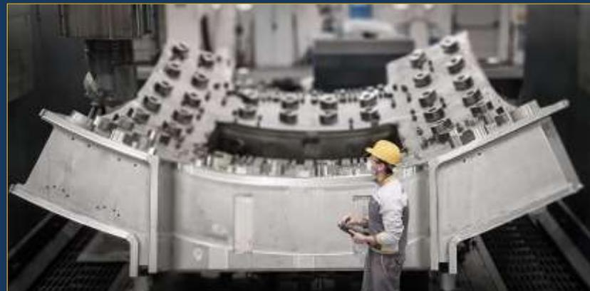
Chambre à vide: l'Europe fabrique 5 des 9 secteurs de la chambre à vide du Tokamak. Tous sont en cours de fabrication avec des taux de finalisation allant de 66% à 89%.
